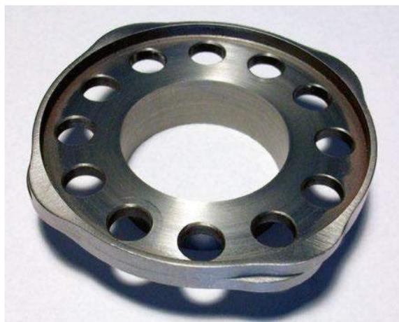
▲ Il est maintenant temps de passer à la distribution. Je commence donc le plateau à cames. Ce plateau est muni de 4 cames d'admission et de 4 cames d'échappement. Il est taillé dans un rond de 42CD4 et intègre la couronne de distribution. Afin de minimiser l'usure due aux frottements des poussoirs, il a été trempé (ce qui explique sa couleur noire). La couronne en laiton a été achetée auprès du concepteur. Il reçoit en son centre un gros roulement à deux rangées de billes. ▼
