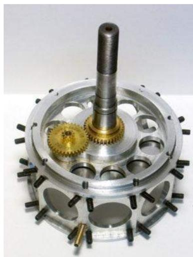
▲ Pour prendre un peu de repos après l'usinage du vilebrequin, je m'attaque à l'assemblage des pignons de la distribution... Ces pignons sont assemblés à la brasure argent, puis les pièces sont montées sur le carter moteur.
