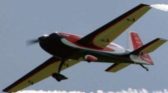
Prochainement présenté dans ces colonnes, le système Smoke EL : il s'agit de fumigènes électriques qui peuvent être activés et coupés à volonté (contrairement à un fumigène chimique). De l'huile de paraffine est tout simplement injectée sur une bougie (genre bougie de préchauffage) avec une pompe électrique.
