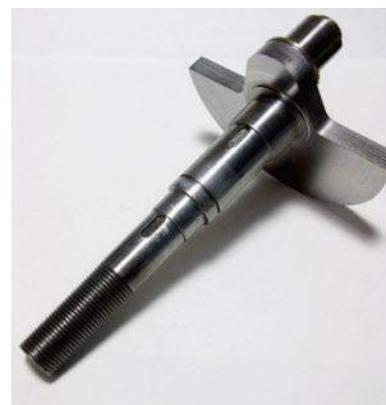
▲ Le vilebrequin est entièrement taillé dans la masse à partir d'un bloc d'acier prétraité 42CD4. Le rondin pèse 5500 g avant son usinage et à peine 225 g une fois l'usinage terminé...
