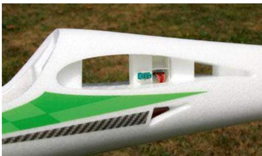
Rare sur une « mousse » : une pièce en plastique supporte des prises 6 broches. Lorsque l'on emmanche les ailes sur le fuselage, les servos sont automatiquement connectés.
