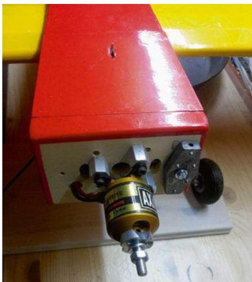
Le moteur utilisé ici est un Axi 2217/12, plus léger que le brushless préconisé. Du coup, il a fallu mettre 50 g de plomb pour le centrage.
