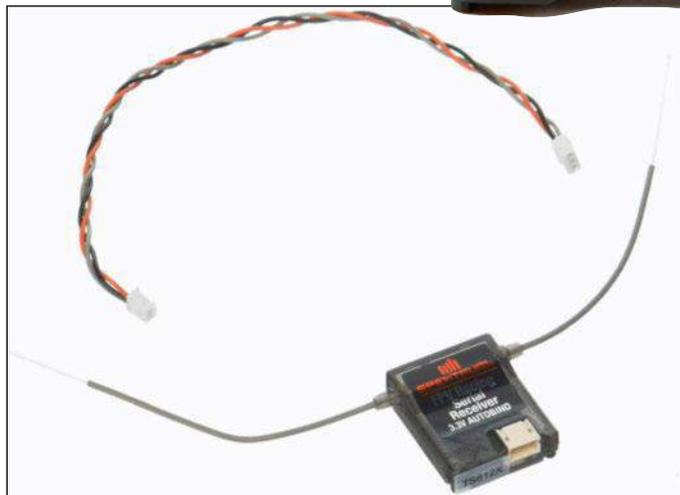
Ce type de récepteur était attendu par les pilotes en Spektrum. Le protocole série SRXL est spécifique à la marque et permet une communication bidirectionnelle (télémetrie) avec les cartes compatibles. Il fonctionne aussi classiquement avec l'ensemble des cartes de vol.
