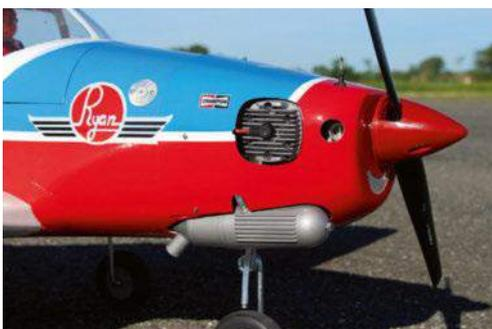
temps. Personnellement, je ne peux me résoudre à faire voler une semi-maquette sans le « doux bruit » d'un moteur thermique. Le 4-temps est celui qui a la sonorité la plus feutrée, malheureusement sa culasse dépassait vraiment trop du capot. Je me suis donc résolu à acheter un moteur 2 temps 15 cc (ASP 91A) qui restera plus discret sous le petit capot du Ryan, à condition de bien s'appliquer dans la découpe.
