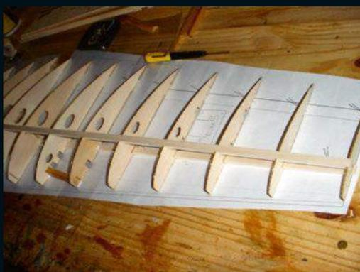
Assemblage de l'aile gauche : une structure classique avec des longerons en balsa 10x5 mm.
