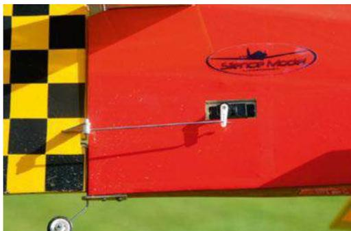
A l'arrière du fuselage, on trouve les servos de dérive et de profondeur, fixé sur les flancs.
