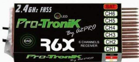
Pas de Sbus sur ce récepteur, mais un protocole série PPM d'ancienne génération. Cela ne posera aucun problème en usage loisir.
