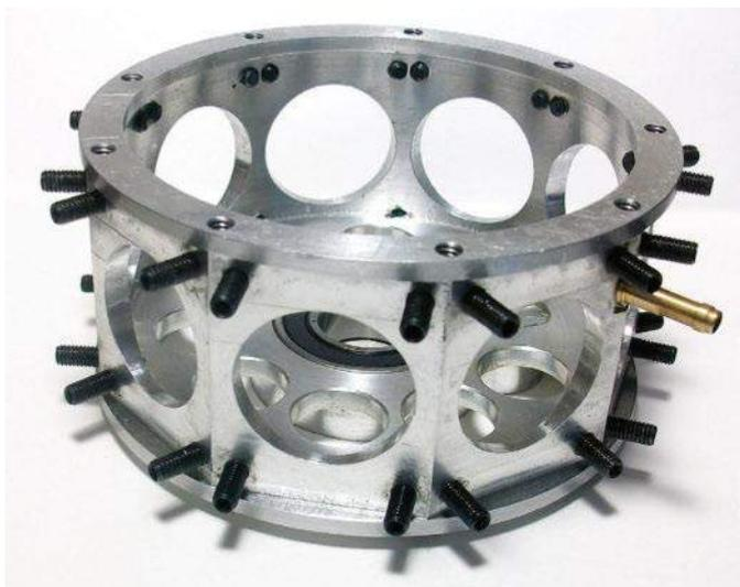
◀ Le carter principal est usiné en aluminium 7075 (appelé aussi aluminium aviation) qui se caractérise par sa très grande résistance, utile lorsque l'on doit effectuer des taraudages car le risque d'arracher les filets lors du serrage des vis est bien moindre.
