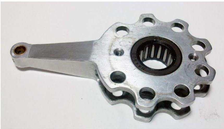
◀ L'ensemble des bielles sera fait en 7075 et en bronze pour les paliers. La bielle mère est montée sur un roulement à aiguilles.
