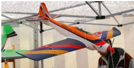
Le Furious 200 de HSDhobby est un modèle en mousse livrable en kit nu ou équipé (envergure 1,3 m). Avec un accu LiPo 4S, la vitesse annoncée est de 160 km/h.
