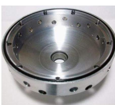
▲ Le carter avant est usiné (en 7075), il possède aussi un joint torique afin d'en assurer l'étanchéité. On passe alors à la fabrication du carter d'admission. Il est réalisé au tour, et les différents perçages sont fait à l'aide du 4<sup>e</sup> axe de la fraiseuse.
