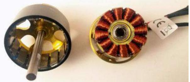
Démontés, les éléments montrent un niveau de réalisation qui fait référence. La qualité des enroulements est sans reproche : on est loin des fabrications bas de gamme où les enroulements sont anarchiques.
