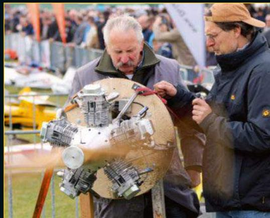
Apparemment destiné à un Bucker au 1/1,25 de 140 kg, ce 5 cylindres en étoile a une cylindrée de 1100 cc et entraîne une hélice 60x21. Il a été construit à partir de cylindres Honda.
