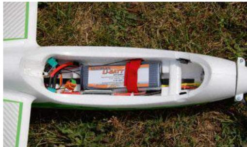
Il y a de la place dans le fuselage. L'accu LiPo 3S 3200 mAh assure une excellente autonomie.
