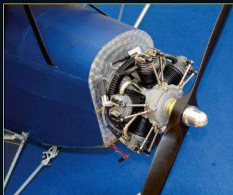
Ce H80 proposé par Fun Modelbau est un 85 cc 5 cylindres en étoile fonctionnant à l'essence. Il pèse 3 200 g et développe une traction statique de 12 kg avec une hélice 24x12. 2395 €.
