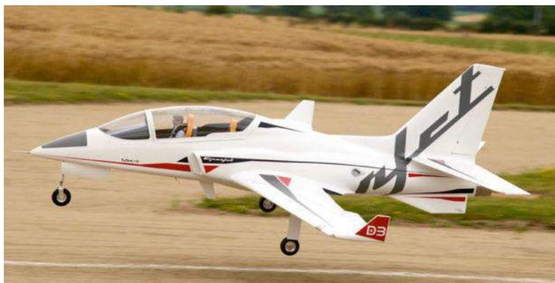
Le Viperjet Paritech de Christophe Baudrillard possède des qualités de vol remarquables. Il est motorisé par un réacteur FT 200 et pèse 24 kg.
