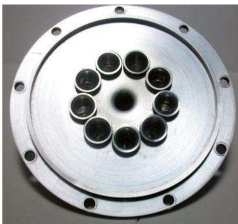
▲ Les trompettes d'admission sont emmanchées en force et le montage est assuré par du produit Loctite « Bloc-pressé ». Le carter d'admission possède lui aussi un joint sur sa périphérie afin de garantir la bonne étanchéité.
