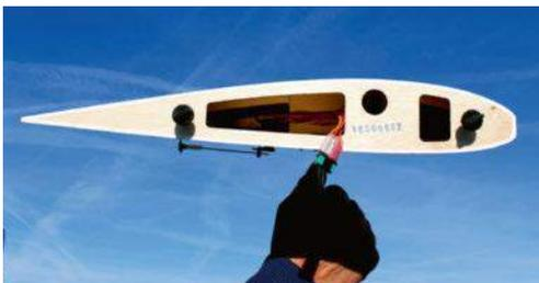
Le fuselage est large et bien accessible, laissant beaucoup de place pour l'installation radio. L'auteur a préféré ne monter qu'un seul servo de profondeur, en reliant les deux commandes.
