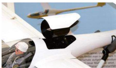
Les turbines électriques rétractables pour planeurs semblent être une solution idéale sur des gros planeurs: un taux de montée efficace, plus besoin de remorqueur et un look préservé une fois la turbine rentrée.
