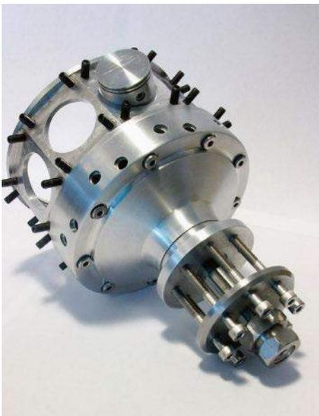
▲ Comme j'aime bien alterner l'usinage de pièces complexes et de pièces simples, je me détends en usinant le plateau d'hélice. Le plateau arrière est fait en 7075 et possède un passage de clavette réalisé par brochage, la partie avant est en acier S300 car il ne demande pas une grande résistance. Les écrous de fixation sont faits avec la même matière.
