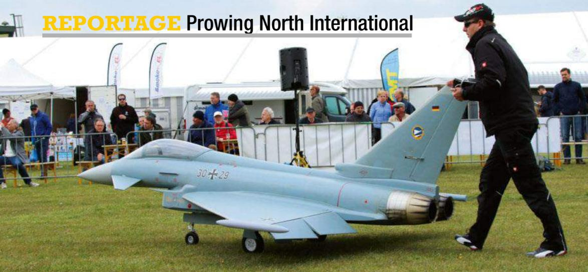
Fabrication personnelle de Florian Keilwitz pour cet énorme Eurofighter. L'envergure est de 2,65 m pour 3,75 m de long. Ce jet qui est à l'échelle 1/4,3 pèse 66 kg et est motorisé par deux turbines BF 300 (poussée unitaire 30 kg). Les réservoirs ont une contenance de 11 litres...
