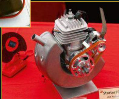
Présenté par 3 W, ce 28 cc 2 temps essence est équipé d'un pot annulaire mais aussi et surtout d'un brushless entraîné par une courroie. Il fait à la fois office de démarreur, mais aussi de générateur pour fournir de l'électricité à bord...
