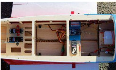
De chaque côté du réservoir, on trouve la batterie de réception et celle du réchauffage de bougie. L'assise du réservoir est ici modifiée avec des baguettes triangulaires et des crochets pour le maintenir avec des élastiques.
