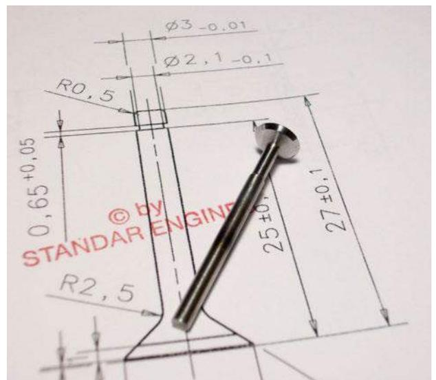
▲ Les soupapes sont en 42CD4, taillées dans la masse. Si leur réalisation ne pose pas de problèmes, il n'en est pas de même pour leur rodage. Cette opération prend un temps considérable: 10 à 15 minutes par soupape, et je rappelle qu'il y en a 18! Une étanchéité sans faille est absolument nécessaire si on veut obtenir un fonctionnement correct de l'ensemble. C'est d'autant plus important sur un multicylindre, car il est difficile de déceler un cylindre défaillant.
