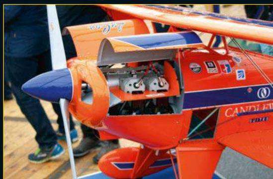
Installation remarquable sur ce Pitts, avec un 4 cylindres à plat 4 temps de Kolm Engines (240 cc). Le moteur à lui seul pèse 8 kg...
