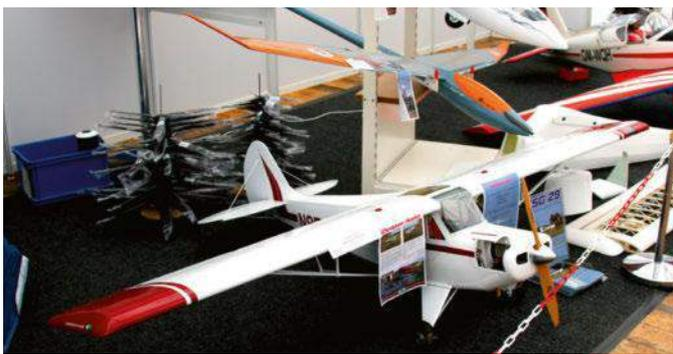
Proposé par Engel Modellbau, ce Christen Husky fait 2,69 m d'envergure et sera motorisé par un 35 cc. Fuselage en fibre de verre, ailes à construire en structure bois (pièces fournies, découpées CNC).
