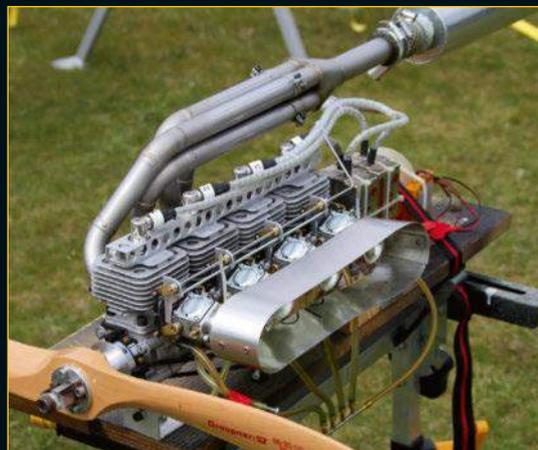
De construction personnelle, ce 4 cylindres en ligne est fabriqué à partir de cylindres du commerce. Il fait 104 cc et entraîne une hélice 26x10 à 6400 tr/min. Il y a un carburateur et un boîtier d'allumage par cylindre.
