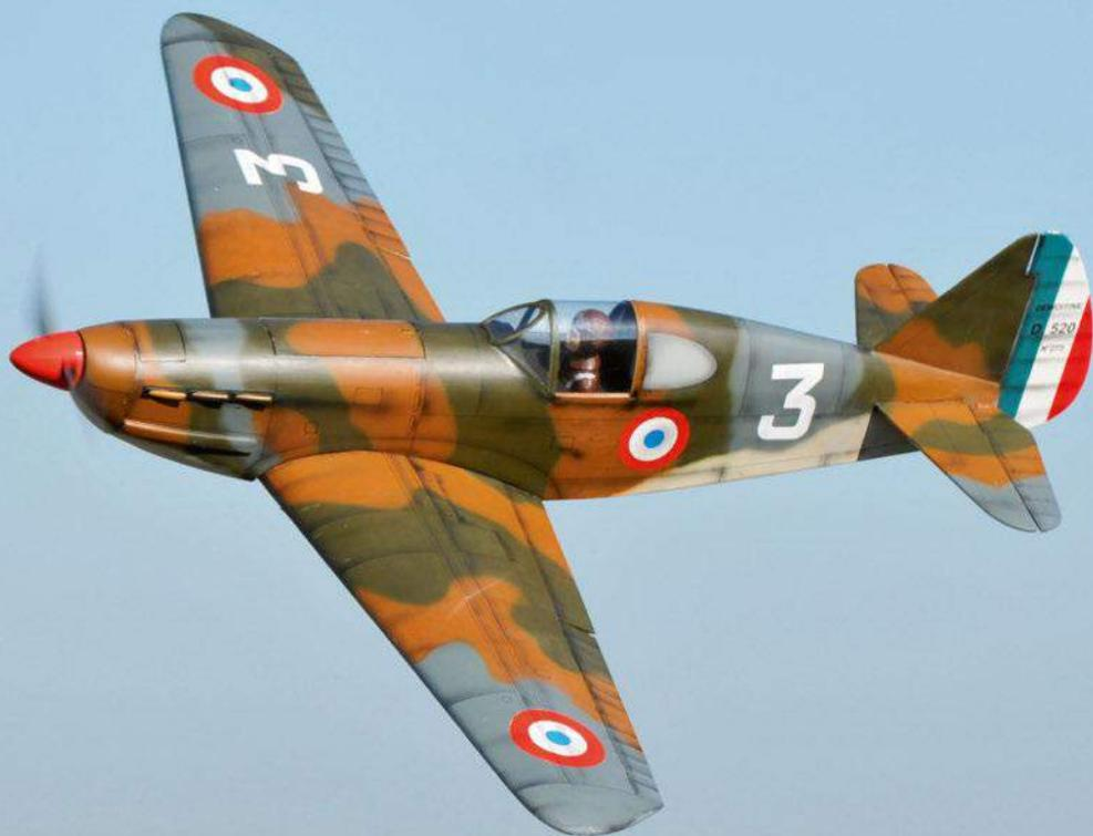
couche de vernis incolore satiné vient recouvrir l'ensemble. Dernier détail qui apporte un peu de relief, les six pipes d'échappement obtenues par impression 3D et qui sont collées de chaque côté du capot.
