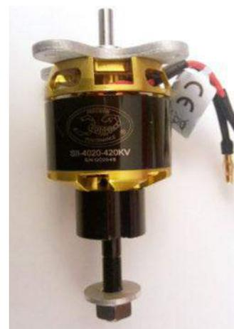
Des prises PK 4 mm équipent le 4020 d'origine. Deux supports d'hélice sont fournis: une pince et celui visible ici, qui sera sans doute le montage le plus courant. Ce support d'hélice est assez épais, ce qui peut être pénalisant si la place est comptée entre le couple pare-feu et le capot moteur.
