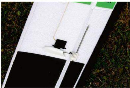
Les gouvernes (ailerons, volets, profondeur) sont rigidifiées par des tubes en acier inoxydable et les palonniers des servos (Hitec HS-65 HB) sont protégés par des caches en plastique.
