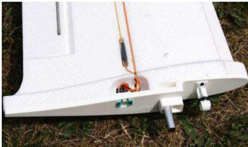
La nervure d'emplanture est en plastique. De droite à gauche, on voit le système de fixation, le longeron qui fait office de clé d'ailes et la prise 6 broches pour les servos.
