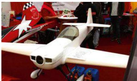
La marque Delro propose ce joli Cap 232 avec une envergure de 2,25 m. Poids en ordre de vol 7,5 à 9,3 kg, pour moteur 55 à 70 cc. Fuselage fibre et ailes en polystyrène coffré.
