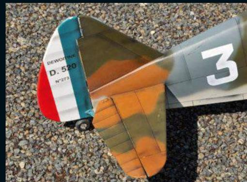
L'entoilage est ici réalisé en film thermorétractable Oracover, recouvert ensuite de peinture mate. Le travail de finition (lignes de structure au feutre fin, vieillissement) donne du vécu à la machine.
