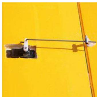
Chaque aileron est manoeuvré par un servo au format 11 g.
