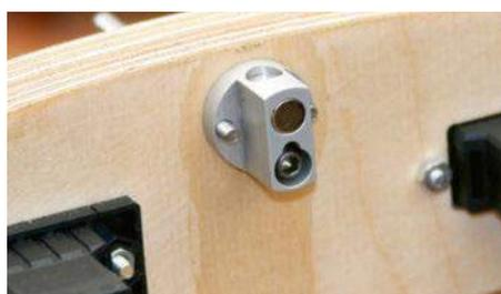
Toujours chez Emcotec, ce système de verrouillage des ailes est révolutionnaire et s'active simplement en passant un aimant. Plus de vis à mettre, ça se verrouille et se déverrouille en moins d'une seconde!
