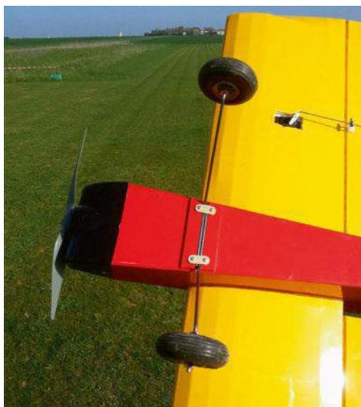
Le train en cap est simplement fixé sous le fuselage avec des petits cavaliers en ctp.
