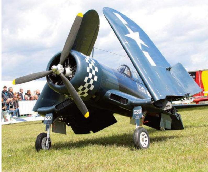
Toujours aussi magique : le Corsair F4U de Carf Models, avec repliement hydraulique des ailes... Moteur Moki 5 cylindres en étoile de 250 cc.
