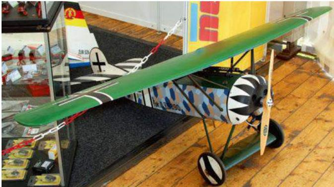
Ce Fokker DVIII est a priori issu d'un kit à construire Balsa USA. Envergure 2,08 m, moteur Roto 4 temps 35cc.
