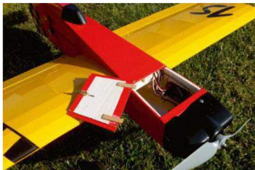
Une trappe supérieure a été réalisée pour accéder à l'accu.
