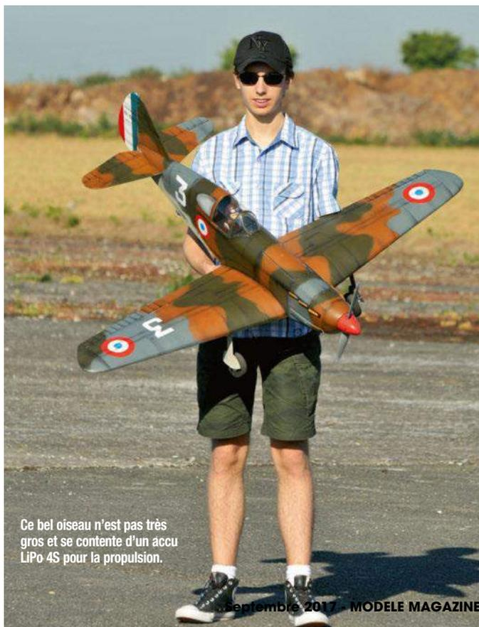
Ce bel oiseau n'est pas très gros et se contente d'un accu LiPo 4S pour la propulsion.
