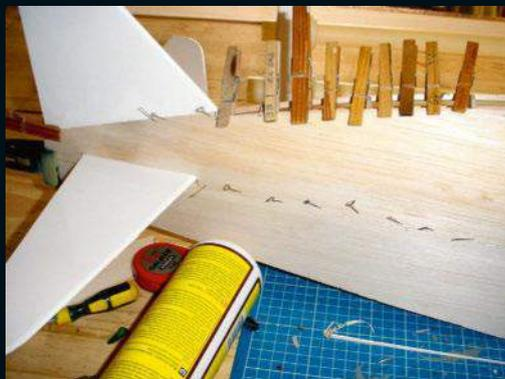
Collage du coffrage sur la partie dorsale arrière du fuselage.
