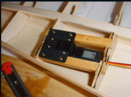
Mise en place provisoire de la mécanique du train rentrant électrique pour vérification.
